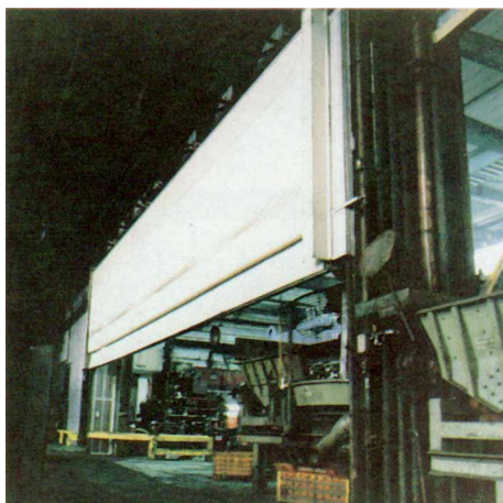
Abtrennung eines Arbeitsbereichs
