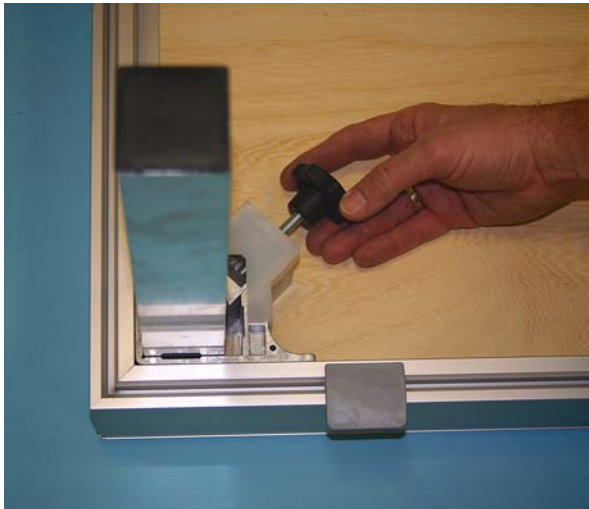
Steckbein in die Fußaufnahme stecken und mittels Sterngriff festziehen. Für alle 4 Füße gleich verfahren
